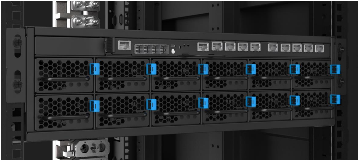
图2-5 集中供电Power Shelf、PSU及管理控制器
