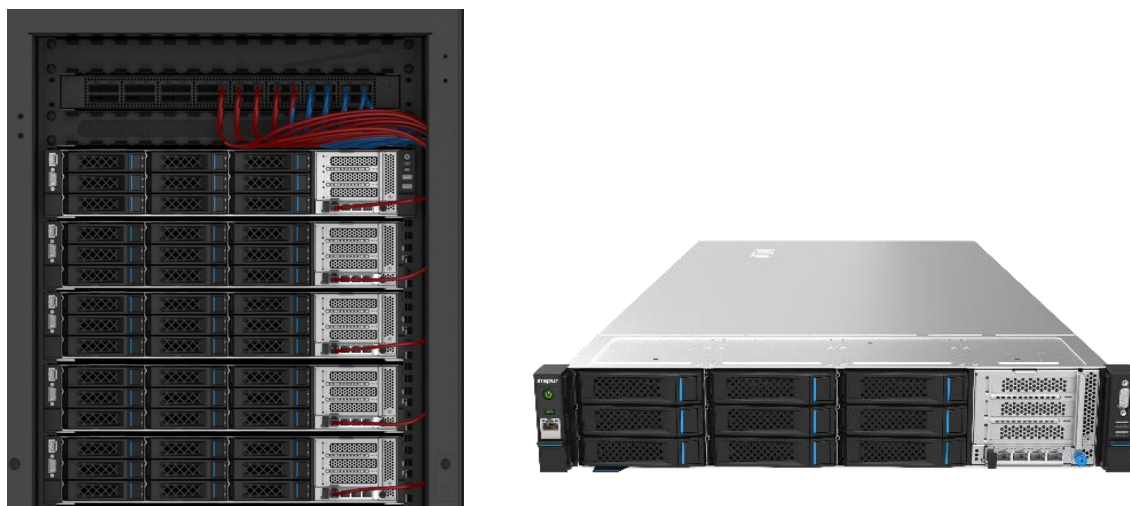
图2-9 天枢前出线服务器架构及上架前侧板布线方案
