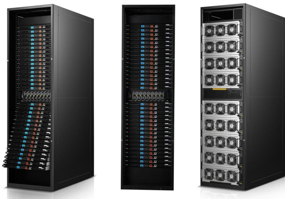
图1-9 天蝎2.0架构支持集中供电、集中散热、集中管理
