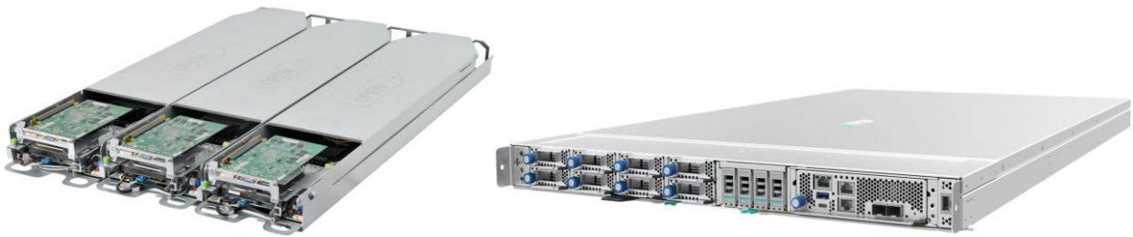
图2-11 ORV2 20U3Node布局与21英寸1U液冷节点布局
