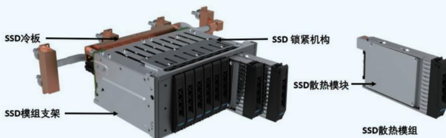
图6. 创新的固态硬盘液冷方案
