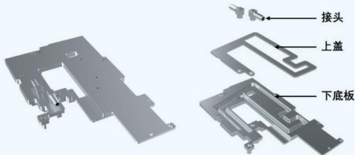
图18. 铝IO冷板图
