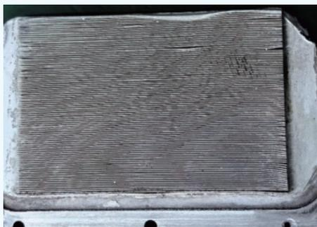
图21. 冷板内部结构图
