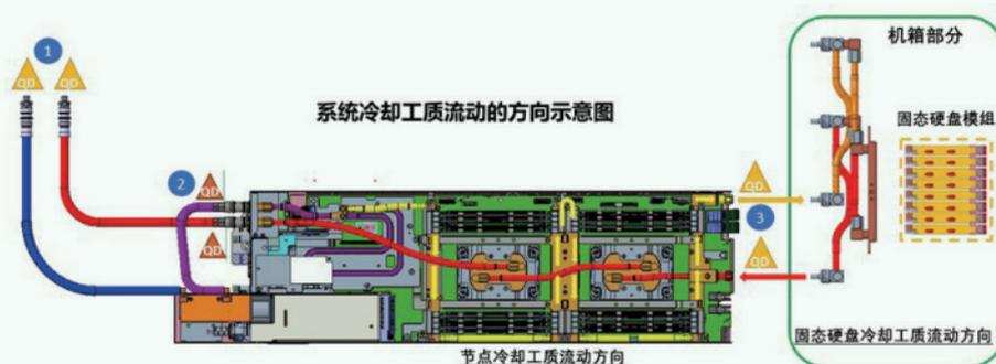
图3. 2U四节点全液冷服务器串联流路
