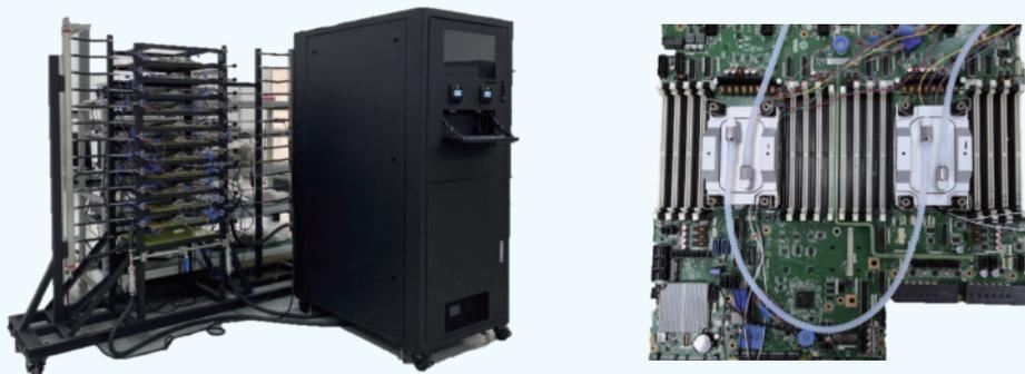
图19. 冷板冷却工质兼容性测试平台
