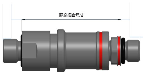
图4 流体快插接头静态插合尺寸示意图
