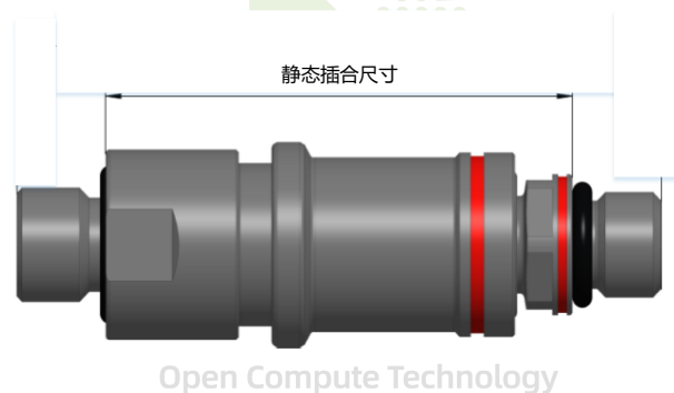
图4 流体快插接头静态插合尺寸示意图
